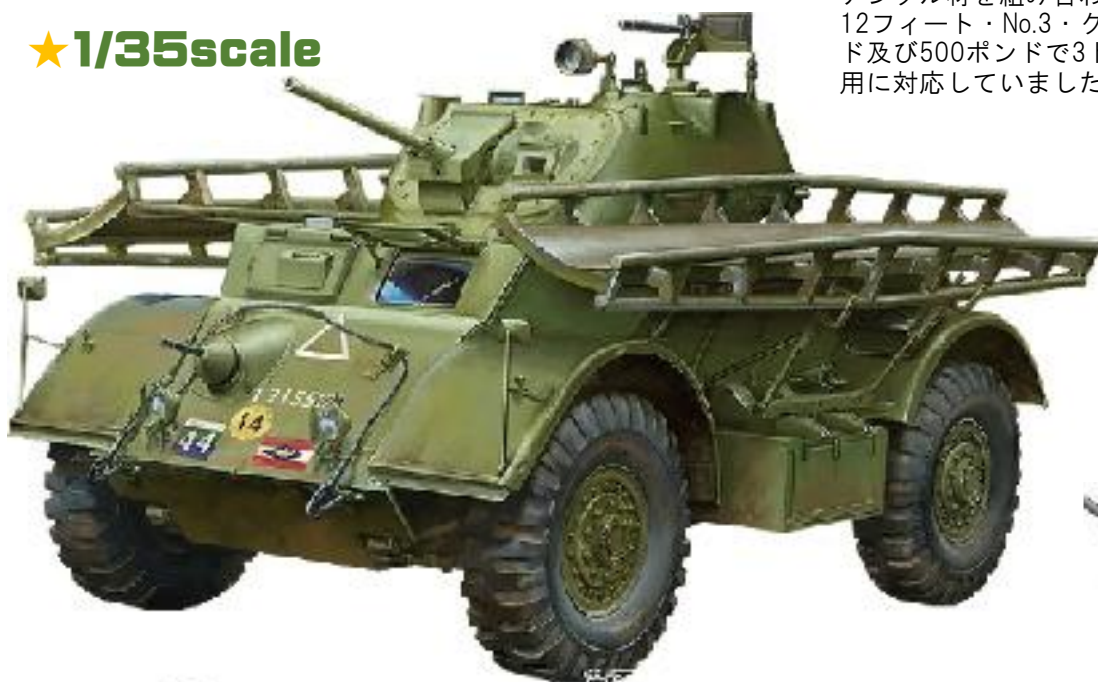
突撃橋はパイプと鋼材を組み合わせたシンプルな構造です
