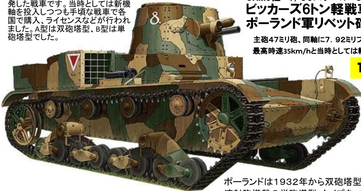
ポーランドは1932年から双砲塔型のAタイプを22両、速射砲搭載の単砲塔型Bタイプを16両輸入採用しました。機銃はオリジナルのビッカース機銃からブローニング機銃に変更されています。後にライセンス生産権を購入しポーランド独自改良を行った7TPを生産しています。
