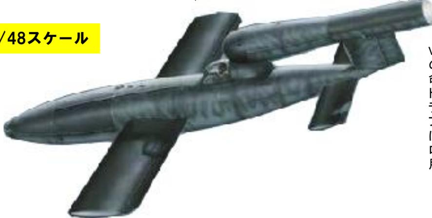
V-1は画期的な兵器でしたがやはり、飛行中の回避不能などで大きな損害を出し、また、命中精度の低さから重要目標をピンポイント攻撃などは不可能でした。そこで、ハンナ・ライチェなどが提唱し有人型が開発されライフエンベルグ計画として試作されました。特に対艦攻撃用として期待されましたがパイロットの脱出の困難さやミステル計画の実用化などで計画は中止されました。
