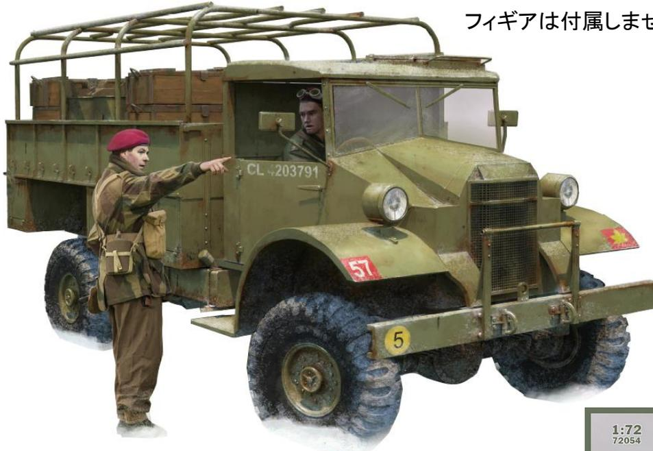
シボレーC30Aはホイールベース3.41mで積載量30cwt(ハンドレットウェイト)・メートルトンだと1.5tとなります。Aは四輪駆動タイプです。
