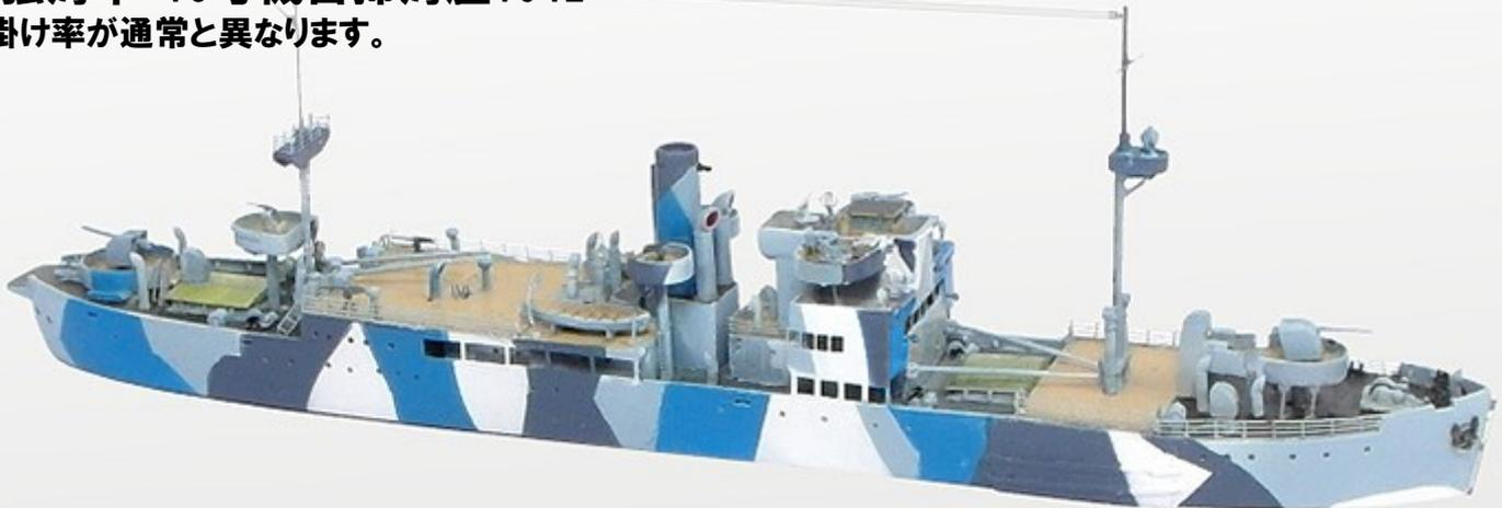
5000トンクラス商船を改修した機雷掃海艦。100隻あまりが改修される。18号艦は民間船SCHÜRBEKを徴用、改造。磁気機雷対応用にVESシステムを搭載。港湾から外洋の間に投下される機雷に対して先導するのが任務。1945年爆撃で大破。10.5cm砲2門・3.7cm連装砲2基・2cm単装砲3基
