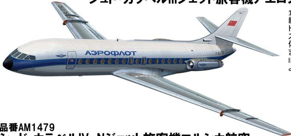
1958年に就航した西側初の短中距離路線用のジェット旅客機です。DH106コメットの技術を流用することで開発時間とコストを抑えながら革新的な十字尾翼や胴体後部のエンジン配置などを採用しています。III型はシリーズの最多生産機で初期型よりもペイロードを拡大しています。
