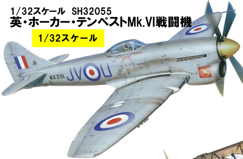
テンペストVI型はエンジンを強力なセイバーV型に変更したタイプです。ラジエターの大型化や防塵フィルターの装着、主翼前面に増設されたオイルクーラーなど形状も変化しています。戦後、主に中東方面に展開しました。デカールは4種類です。
