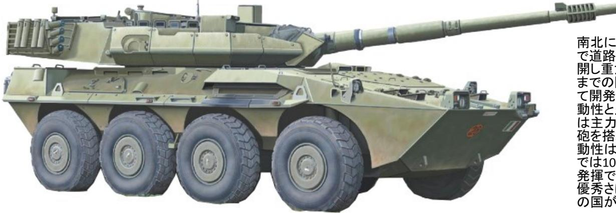
南北に長いイタリアの防衛で道路網を使って素早く展開し重武装部隊が到着するまでの間を埋める車両として開発されました。特に機動性と火力を重視し主砲には主力戦車並みの105mm砲を搭載しています。また機動性は25トンながら道路上では100kmを超える速度を発揮できます。この車両の優秀さは他国も注目し複数の国が採用しました。
