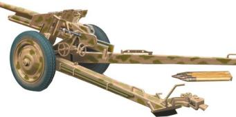
独ソ戦初期に大量に鹵獲したソ連軍F-22・ 76.2mm野砲をドイツ軍が対戦車砲として改造し たのが本砲です。防盾は上部を切り詰め高さを 低くし2重化、操作ハンドルは砲手一人で操作で きるように左側にまとめ、薬室を拡大しPak40用 の薬莢を使えるようにし威力を増し、それに伴い 後座量を減らすためマズルブレーキを装着する などしています。弾薬はPak40用の薬莢に7.62cm の砲弾を取り付けた特製弾薬が用意されました。 T-34などのソ連戦車に対抗するため早急に用意 されドイツ製の対戦車砲が出揃うまでのギャップ を埋めました。
