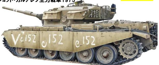
イスラエルがセンチュリオンを改造したのがショットです。各 国から入手した中古のセンチュリオンを1000両近くを保持し ていたイスラエルは近代化改修を行い第一線で使えるよう に改造を行いました。主砲は105mmL7に換装、エンジン・ト ランスミッションはM60系と同じ米国製ディーゼルに変更、射 撃管制装置なども近代化するなど行いました。1973年の第 四次中東戦争では大いに活躍しました。センチュリオン自体 のキャパシティの高さから改修は容易に進みイスラエルの 戦車開発に大きな影響を与えました。
