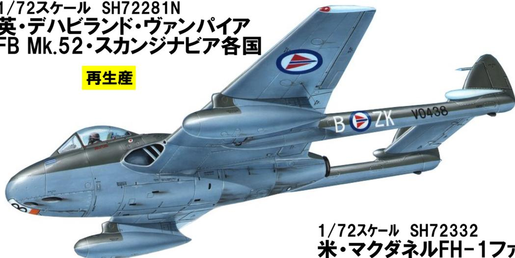
新たな動力としてジェットエンジンが開発され飛行機の形態の模索が始まりました。デハビランドでは短い胴体後部にエンジンを置き、尾翼は主力から伸ばしたブームで支える形態をとりました。ヴァンパイアは戦後第一世代のジェット機として成功をおさめイギリスだけでなく広く各国でも採用されました。
