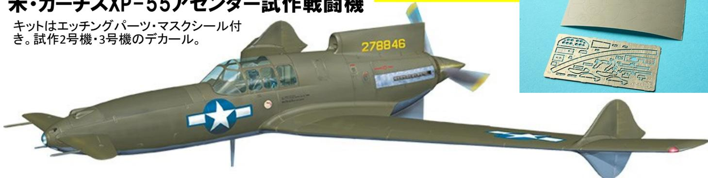
1939年アメリカ陸軍が提示した単発迎撃機構想にカーチスが提出した案です。他にバルティエXP-54・ノースロップXP-56が提出されました。どの機体も開発中のP&W・X-1800エンジンを搭載する予定でした。XP-55は先尾翼・推進式エンジンが特徴でした。しかしX-1800エンジンの開発は失敗し代わりに1000馬力も出力が低いアリソンエンジンを搭載し試験飛行が行なわれました。1943年に初飛行が行なわれましたが出力不足は勿論、安定性不良や操縦性不良など問題が続出で3機が製作されましたが開発は中止されました。
