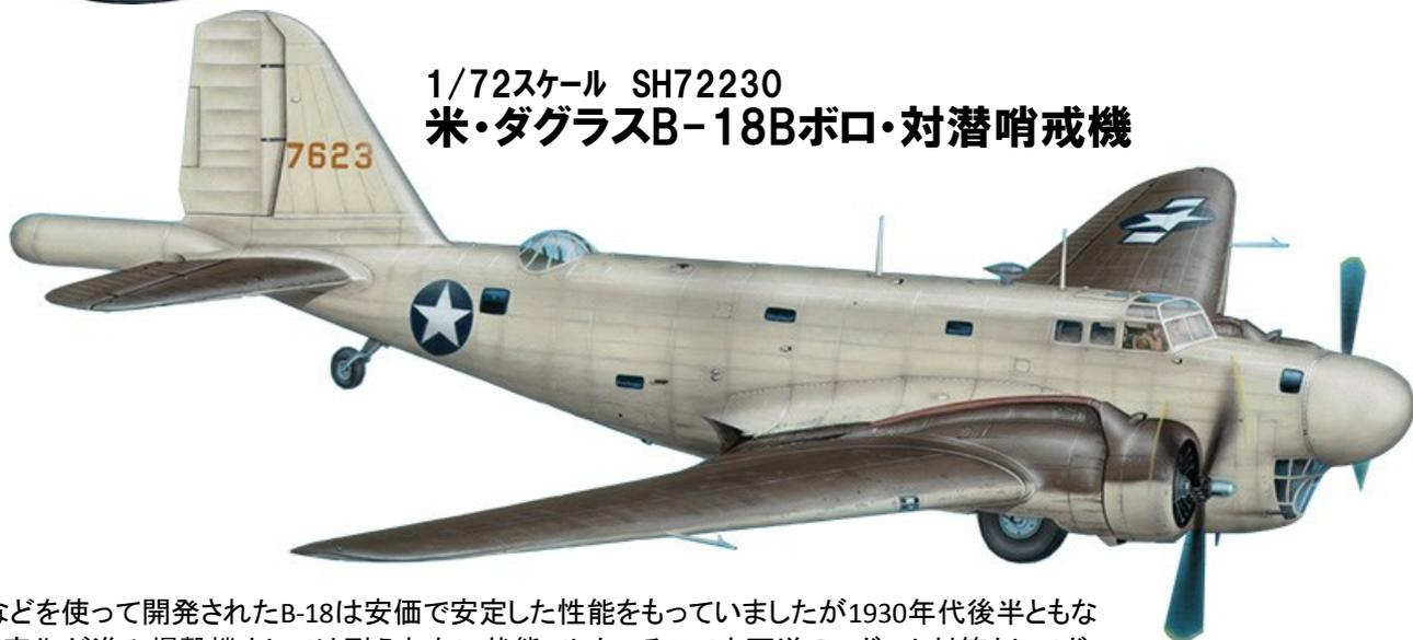
DC-2の主翼などを使って開発されたB-18は安価で安定した性能をもっていました。1930年代後半ともなると性能の陳腐化が進み爆撃機としては耐えられない状態でした。そこで大西洋のUボート対策としてボロを改造し対潜哨戒機として運用することになりました。尾部に磁気探知機(MAD)のブームを取り付け哨戒に当たりました。120機あまりが改造され1943年まで運用されました。
