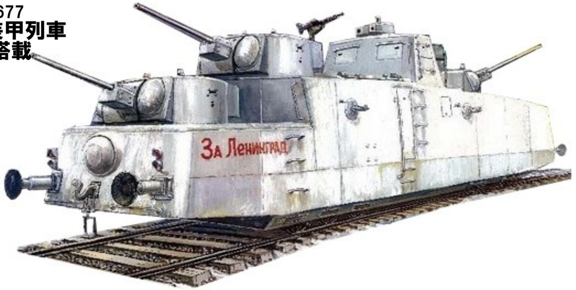
1937年にレニングラードのキーロフ工場で作られた自走装甲列車です。当初は76.2mmL-11砲を搭載していましたが大戦中にT-34の防盾ごと新型の76.2mmF-34に換装しました。砲塔本体は元のT-28用を使用しT-34の防盾傾斜角に合わせた台座を増設し砲を装備しています。独ソ戦ではレニングラード戦域で火力支援などに使われました。現在はクビンカで展示されています。
