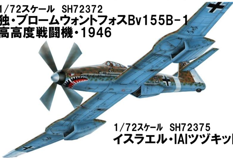
元々はメッサーシュミット社が開発していた艦上戦闘機でした。しかしブロームウォントフォス社が開発が委譲され高高度邀撃機として再開発されることになりました。長大な流層翼断面の主翼中央に巨大なラジエーターが装備され操縦席は与圧されていました。V-1の飛行は1945年2月になり終戦までにわずか2機の完成にとどまりました。キットは実戦参加仕様のマーキングです。
