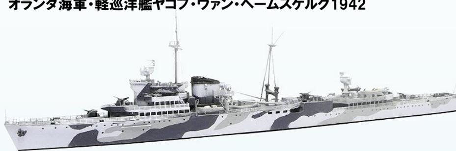
トロンプ級巡洋艦の2番艦。全長132m、排水量4800トン、蒸気タービンで32ノットを発揮。起工は1938年10月、しかしドイツ軍のオランダ侵攻のため1939年10月には工事未了のまま英国に出国。英国で武装などを搭載されるがオリジナルの15cm砲が手に入らないため英国の102mm連装高角砲を5基搭載しレーダー装備の防空巡洋艦とされた。1941年に改装は終了し主にインド洋で船団護衛任務などに従事した。船団護衛の合間にマダガスカル上陸作戦などにも参加、1945年には極東に向かうが戦争終結のためオランダに帰国、1951年に除籍1970年スクラップとして解体された。
