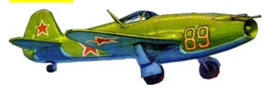
戦後ジェットエンジンの技術を入手 れたソ連ではジェットエンジンを搭載する戦闘機の開発を各設計局に要 求しました。しかし本格的なジェット機は時間がかかるためヤコブレフは大戦中のレプシロ戦闘機Yak-3戦 は人戦中のレックロ戦闘機では5戦 闘機をジェット機に改修しました。 エンジンはドイツのJumo004を国産 化したRD-10を機首に搭載した他は レプシロ機の状態とほぼ変わらない 機体でした。しかしジェット噴流が 機体でした。しかしジェット噴流か 尾輪を溶かすため金属尾輪となって います。ジェット創生期でこれほど 容易に作り上げたソ連の合理性は驚 くべき視点です。後に前輪式になっ たYak17や発展型のYak23に進化して ゆきました。
