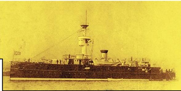
→1898年サンクトペテルブルクで進水。全長63m・排水量1240トン・速力11ノット
