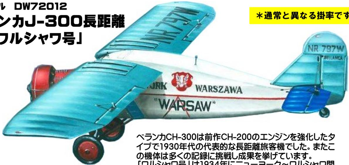
ベランカCH-300は前作CH-200のエンジンを強化したタイプで1930年代の代表的な長距離旅客機でした。またこの機体は多くの記録に挑戦し成果を挙げています。「ワルシャワ号」は1934年にニューヨーク～ワルシャワ間の無着陸飛行を成功させた機体です。
