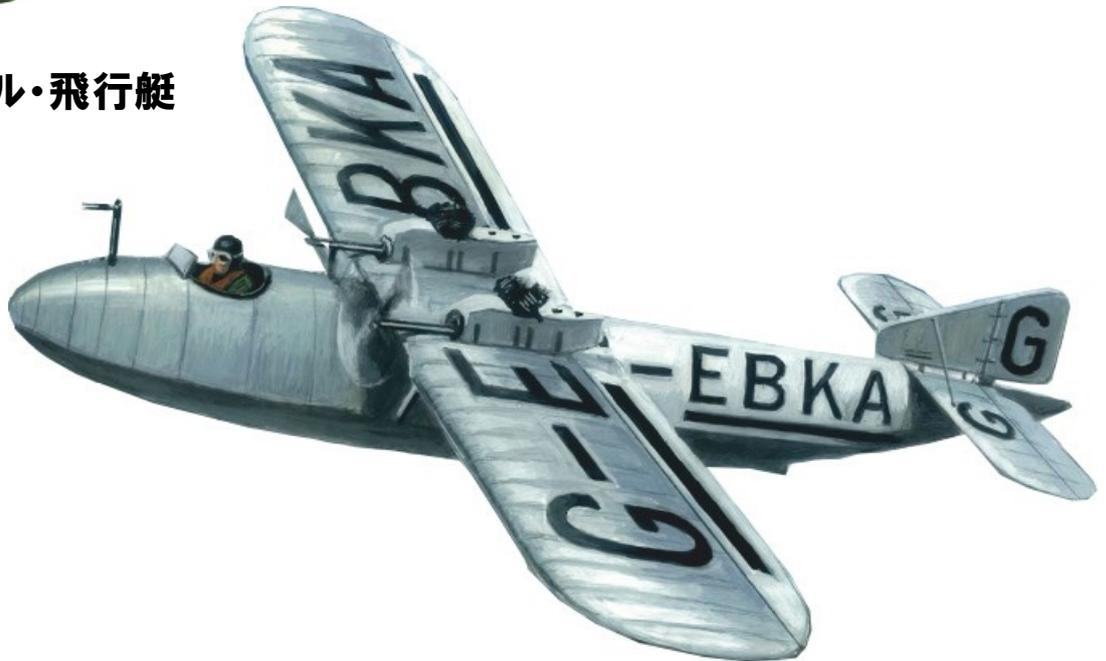
1924年開発された初の金属製飛行艇です。翼の外皮板外は全て金属製で構成されており当時としては画期的な構造でした。エンジンは翼の主桁上に搭載され延長軸でプロペラを回していました。また、エルロンは離着水時にはフラップのように下がり揚力を増す構造でした。オーストラリアからの発注でしたがプロペラを延長軸で回す構造などで十分な馬力を得れず発注は取り消されました。しかし、ショート社はこの機体の作成で金属構造のノウハウを得、後の開発につながる機体でした。
