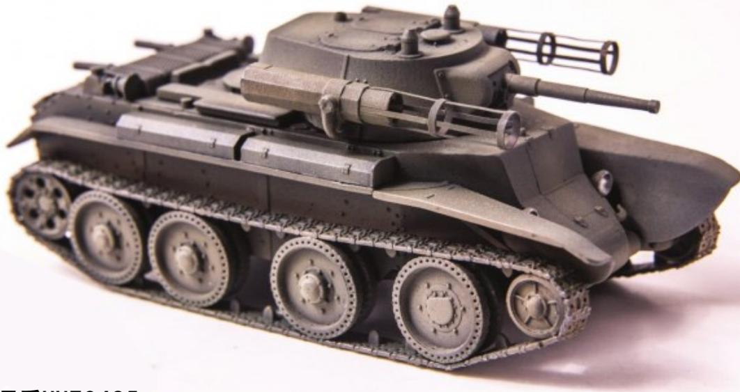
1930年代のソ連軍主力戦車となったBT系統には車体を利用した多くの開発計画が生まれました。これは砲塔の両側にロケット弾を発射するランチャーをつけた試作車です。当時のソ連ではロケット研究が進んでおり兵器開発にも多く使われていました。有名なカチューシャ多連装ロケットを初めとし多くのロケットが開発されていました。戦車の武装にロケットを使用する案も発案されBTに搭載する試験が行われました。
