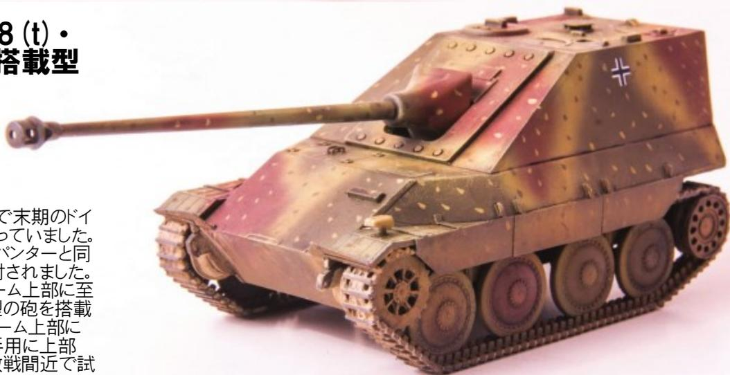
ヘッツァーは急造ながら有効な兵器で末期のドイツ軍には無くてはならない存在となっていました。ヘッツァーの更なる威力向上のためパンターと同じ7.5cmL/70砲を搭載することが検討されました。搭載方法は車体上部にエンジンルーム上部に至るまでの大きな戦闘室を新設し大型の砲を搭載するとされました。乗員はエンジンルーム上部に位置し砲を操作しました。また操縦手用に上部ハッチも増設されています。しかし、敗戦間近で試作車も作成されませんでした。
