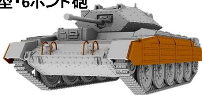
砲塔は前面板が6ポンド砲搭載によってそれまでのタイプと大きく形状が変更されています。
