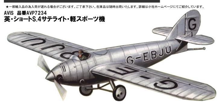
1924年に開発されたスポーツ機です。この年に行なわれる2座飛行機の競技会に出品するため数ヶ月の短い期間で製作されました。そのため胴体は木製フレームハブ張りのオーンドックスな構造で翼のリブにはジュラルミンを使用、外皮はハブ張りでした。競技会ではショート社テストパイロットのJ.L.パーカーが搭乗しましたが乗客1人を搭乗させると馬力不足で競技会では失格となりました。その後エンジンを換装し翼の長さを切り詰めるなど改良されました。この機体でJ.L.パーカーが頻繁に飛行していたので「パーカーの錫ケトル」と渾名されました。
