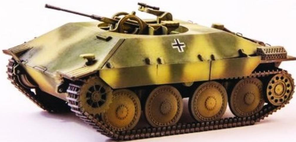
大戦後半のドイツ軍駆逐戦車として大量に生産されたヘツァーは成功作となりその車体をベースとして各種用途別車両が開発されました。偵察用として38(t)軽戦車をベースにしたSd.kfz.140/1などが開発されていましたが新たにヘツァーベースにも開発されました。ベースはヘツァー回収戦車で24口径7.5cm砲をオープントップに搭載したタイプが最初に製作されました。更に2cmKwk38(車載型Flak38)搭載型も開発されました。Kwk38は車内に搭載され砲の上部のみが車外に出ている形状で対空射撃も可能となっていました。試作車は1944年には完成しましたがSd.kfz.234系重装甲車などが配備されている中では新たに生産ラインを作る必要性が認められず試作のみに終わりました。
