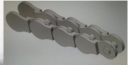
↑仰角を伝えるチェーンです。上部の操作部から下部の油圧シリンダーを操作するための伝達としてチェーンが使われています。
