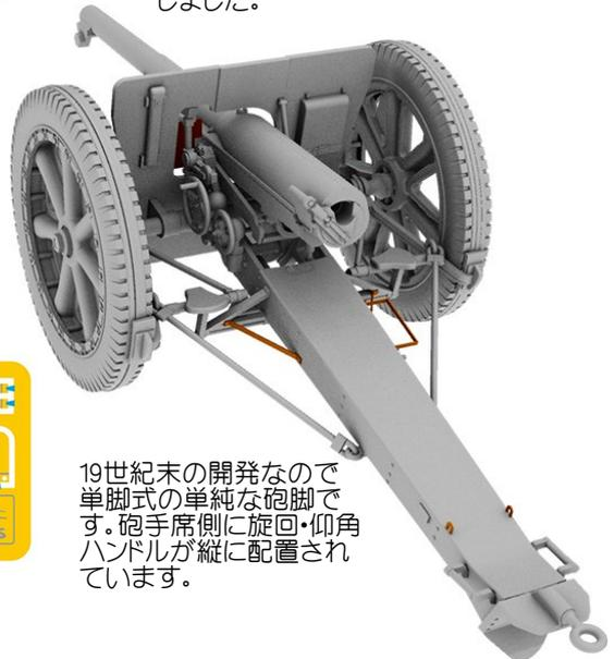
19世紀末の開発なので単脚式の単純な砲脚です。砲手席側に旋回・仰角ハンドルが縦に配置されています。
