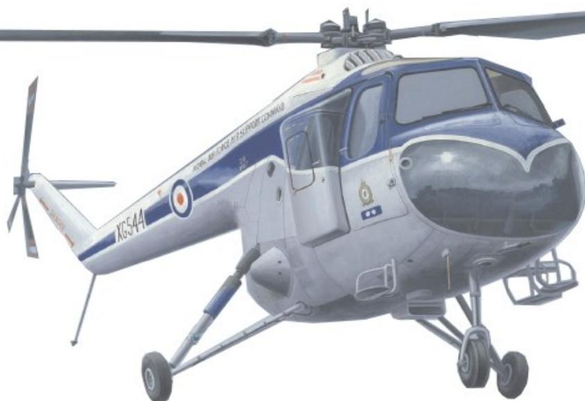
1944年からプリストル社で開発されていたヘリコプターです。1947年に試作機が初飛行し生産が開始されました。550馬力のレブシロエンジンで駆動され主生産型のMk.4では乗員2名の他に乗客3名か1000ポンドの荷物を運搬できました。HR14は英空軍救難型の名称でベースはMk.4です。Mk.52は西ドイツ軍用タイプの名、Mk.14はベルギー軍用タイプです。
