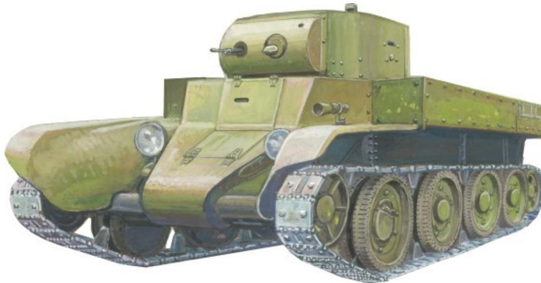
ソ連のトハチーフスキーの元で考案された縦深戦術理論において重要な役割を果たすと期待されたBT戦車には多くのバリエーションが考案されました。HBT-7は砲塔に火炎放射器を装備した化学戦車です。ソ連では火炎放射線車を化学戦車と呼称しています。放射燃料は車体左右のフェンダー上に搭載しています。試作車は作られましたが量産化はされませんでした。
