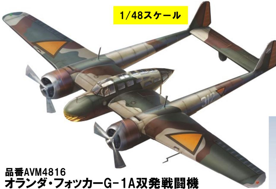
1937年に初飛行した当時各国で流行していた双発長距離多用途戦闘機です。マーキュリーエンジン2基で470kmを出すなど当時としては優秀な機体でした。武装は機首に8丁の7.92mm機銃を並べ後部にも1丁の機銃を装備し300kgまでの爆弾を搭載できました。また後部は広くガラス貼りで偵察にも使えるようになっていました。1940年のドイツ侵攻時は23機が部隊配備されていましたが多くは地上で撃破されました。しかし、迎撃した機体は自身の損害を超える撃墜を果たし一矢をくわえています。最終的に36機が生産されました。
