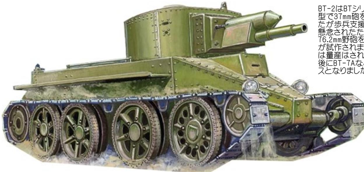
BT-2はBTシリーズ最初の量産型で37mm砲を搭載していましたが歩兵支援には火力不足が懸念されたため火力支援用に76.2mm野砲を搭載したタイプが試作されました。このタイプは量産はされませんでした。後にBT-7Aなどの開発のベースとなりました。
