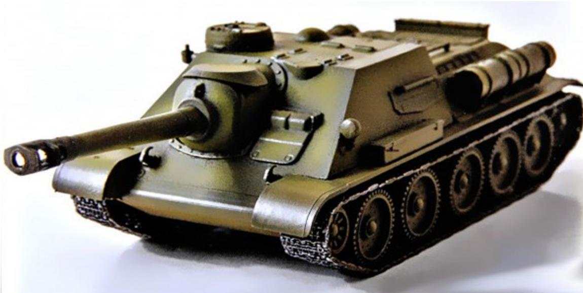
SU-122やSU-85では威力不足だとして152mm砲を搭載する開発が1943年に始まりました。砲は試作のD-15が用いられSU-85のプラントを用い試作されました。同じ152mm砲を搭載するSU-152よりも軽量に仕上がりました。しかし、搭載弾薬量の少なさや重量の増加により負荷が大きくなるなどの問題点があり152mm砲搭載自走砲はKVやJS系のみとなりました。しかし、SU-100の設計に大きな参考となりました。
