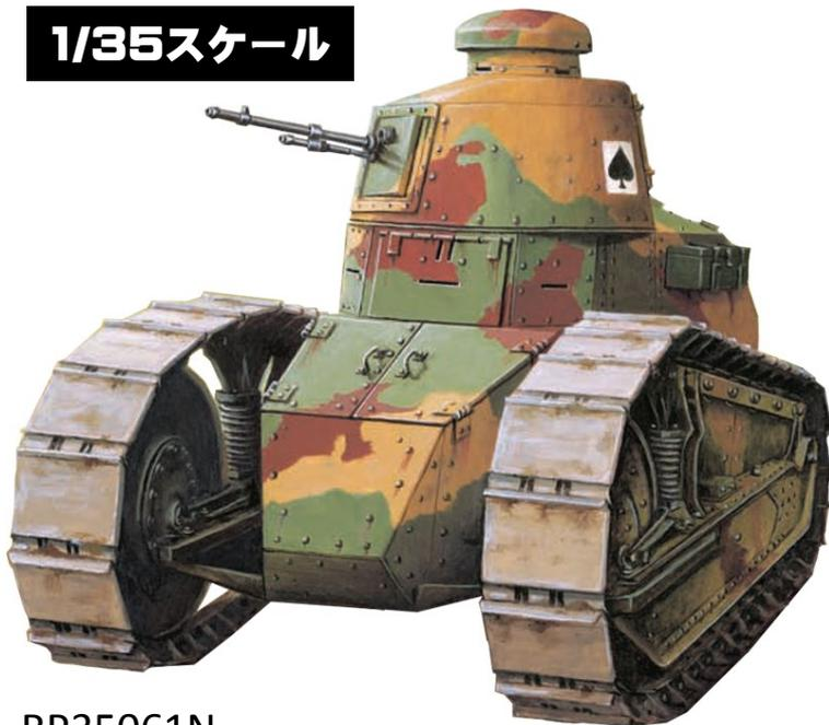
1917年に登場したルノーFTは画期的な戦車でした。車体はセミモノコック構造で軽量化と量産性に寄与しました。また、エンジンと乗員室の間には隔壁が設けられエンジンの騒音や熱から乗員を保護しました。足回りにはサスペンションを備え機動性を高めていました。更に戦闘室には回転砲塔が搭載され少ない武装で全周囲を攻撃できました。砲塔には初期はリベット止め八角形のペリリ工砲塔と後期には鋳造のジドロ砲塔が使われました。大量に生産され各国でも多く採用され一部の車両は第二次大戦でも使われました。
