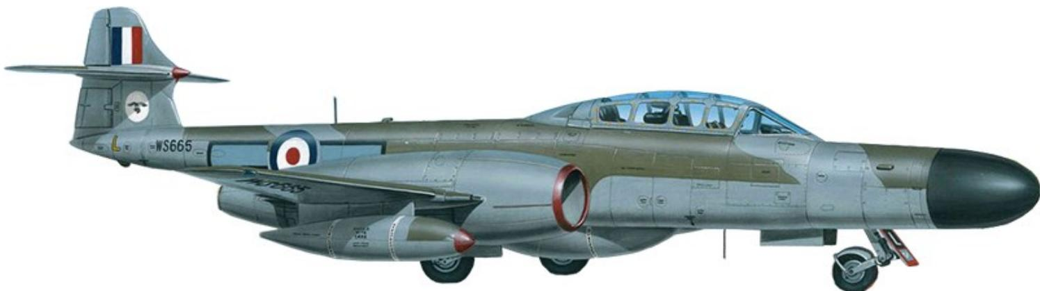
連合軍初のジェット戦闘機として有名なミーティアは多くのバリエーションが存在しました。ミーティアの生産後期はアームストロングホイットワース社で生産されました。NF Mk.12型はT.7複座練習機から発展した複座型で機首に米国製レーダーAPS-21が搭載されています。冷戦初期に核兵器を搭載したソ連爆撃機の脅威から英国を守りました。100機生産され長く防空に使用されました。
