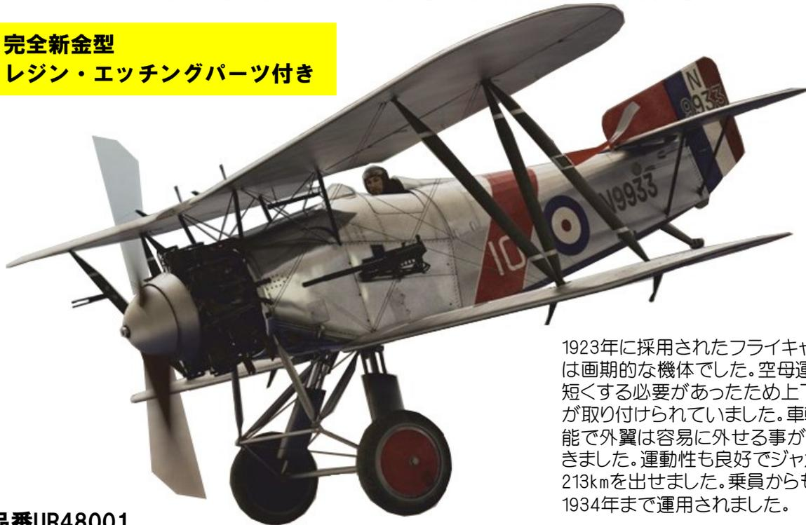
1923年に採用されたフライキャッチャーは当時としては画期的な機体でした。空母運用のため履着距離を短くする必要があったため上下翼には大きなフラップが取り付けられていました。車輪はフロートにも変更可能で外翼は容易に外せる事が出来コンパクトに収納できました。運動性も良好でジャガーIV型エンジンで213kmを出せました。乗員からも好評で海軍航空隊で1934年まで運用されました。
