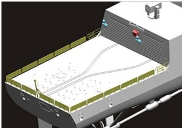
←船体後部のヘリ甲板。周囲の防護ネットはエッチング製。
