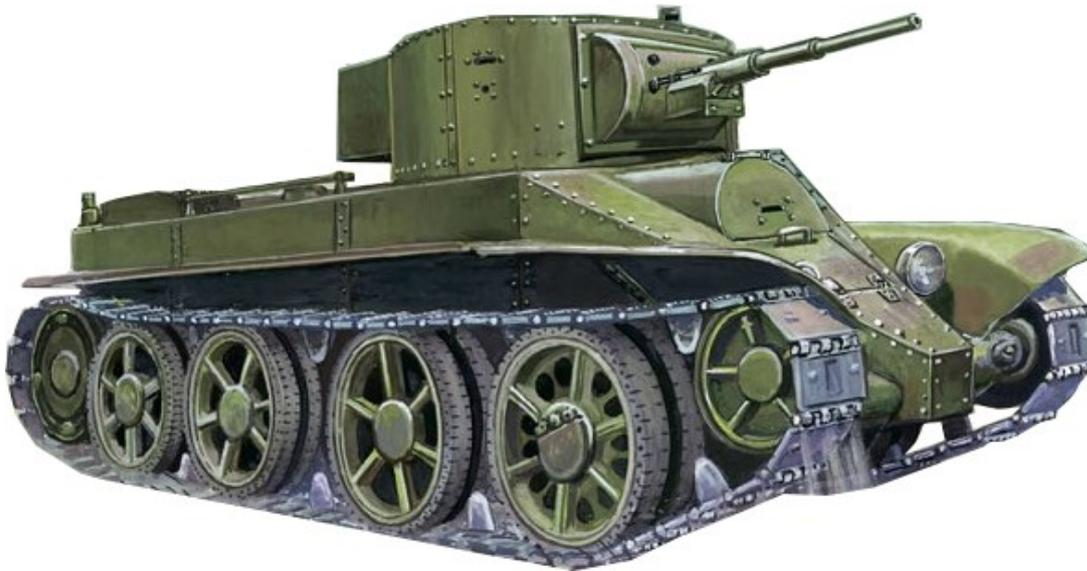
BT-6はBT-5の車体を溶接構造に変更したタイプです。それだけでなく操縦室の張り出しが半円形に変更されています。試作車が製作されましたが車体を全面的にリファインしたBT-7が生産される事になりBT-6は生産されませんが溶接工法の貴重なサンプルとなりました。
