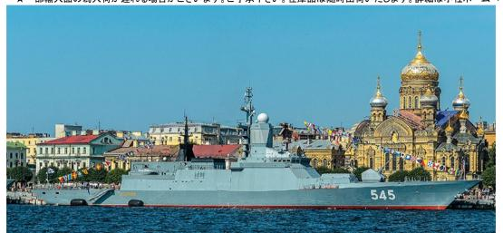
2000年にプーチン大統領が承認した海軍計画で誕生した沿岸用警備艦です。船体は新素材などで軽量化されています。武装は100mm自動砲を前甲板に装備、対艦ミサイルは4連装発射筒2基を装備しています。CIWSのAK-630Mを2基、リドゥート対空ミサイルを装備しています。2011年に就役しバルト艦隊に配備されています。
