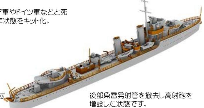
後部魚雷発射管を撤去し高射砲を増設した状態です。
