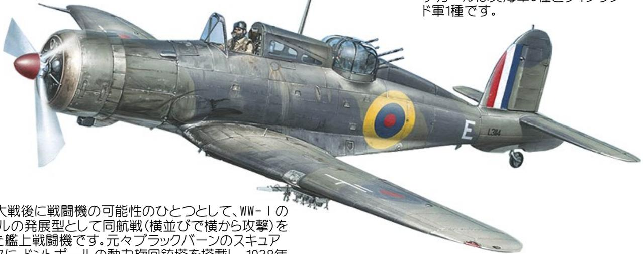
第一次大戦後に戦闘機の可能性のひとつとして、WW-1のプリストルの発展型として同航戦(横並びで横から攻撃)を目指した艦上戦闘機です。元々ブラックバーンのスクエアをベースに、ドントポールの動力旋回銃塔を搭載し、1938年に初飛行しましたが、動力銃塔を搭載し重量の重い複座単発機では、当時の一線機に追いつけるわけもなく、前線部隊からは早々と引きげられてしまいました。しかし、形態は特徴的で、操縦席後ろの7.7mmビッカース機銃4丁を積んだ銃塔は、使用時に前後のフェアリングが収納され、旋回範囲を広げることが出来ます。また、スクエアからの改造とはいえ胴体はほぼ新造されています。安定性を得るための尾翼付近の形状など、銃塔以外にもこの機体の特異な形状が見れるでしょう。
