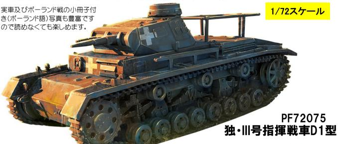
III号指揮戦車D1型は1938年に30両が作られました。砲塔は固定 され主砲はダミーとされボールマウントの機銃が装備されまし た。大型無線機を搭載し車体後部にはフレームアンテナくが装 備され更に砲塔上面ハッチから伸縮式アンテナを展開出来まし た ポーランド戦で宝戦参加しました
