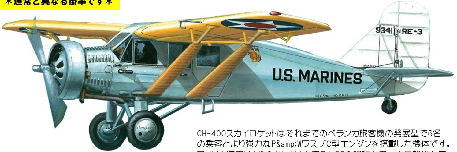
CH-400スカイロケットはそれまでのベランカ旅客機の発展型で6名の乗客とより強力なP&WワスプC型エンジンを搭載した機体です。アメリカ海軍は2機のCH-400を購入しREの略称を用い人員輸送と無線機操作研究に用いました。海兵隊は患者輸送用として担架2台を搭載できるようにし救急搬送用機として運用しました。
