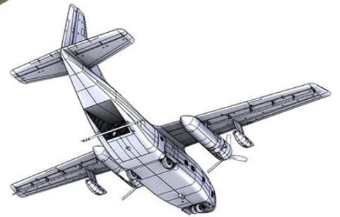
当初は強襲グライダーとして開発されていましたがモーターグライダーとしてエンジンを取り付けられた物が本機のベースとなりました。高翼配置の主翼やスロープ兼用の後部カーゴドア、主脚を胴体外のバルジに装備するなど貨物をより多く、素早く出し入れするための工夫が多く見られその後の輸送機の基本となりました。K型は補助推力として外翼下にジェットエンジンを装備したタイプで多くの機体がK型に改修されました。UC-123はベトナム戦でゲリラが潜むジャングルを無くすために枯葉剤を散布するタイプで主翼や胴体後部に散布用ノズルを装備していました。
