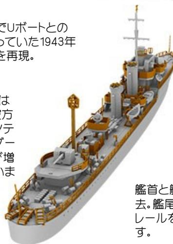
艦首と艦尾の主砲を撤去。艦尾に爆雷投下レールを増設しています。
