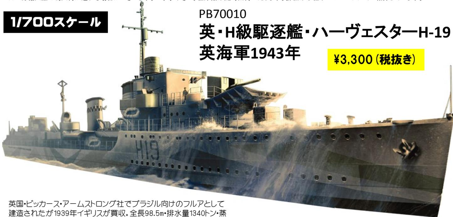
英国・ピッカース・アームストロング社でブラジル向けのフルアとして建造されたが1939年イギリスが買収。全長98.5m・排水量1340トン・蒸気タービン3基2軸・速力36ノット4.7インチMk.IX単装砲4基・4連装魚雷発射管2基・爆雷20個
