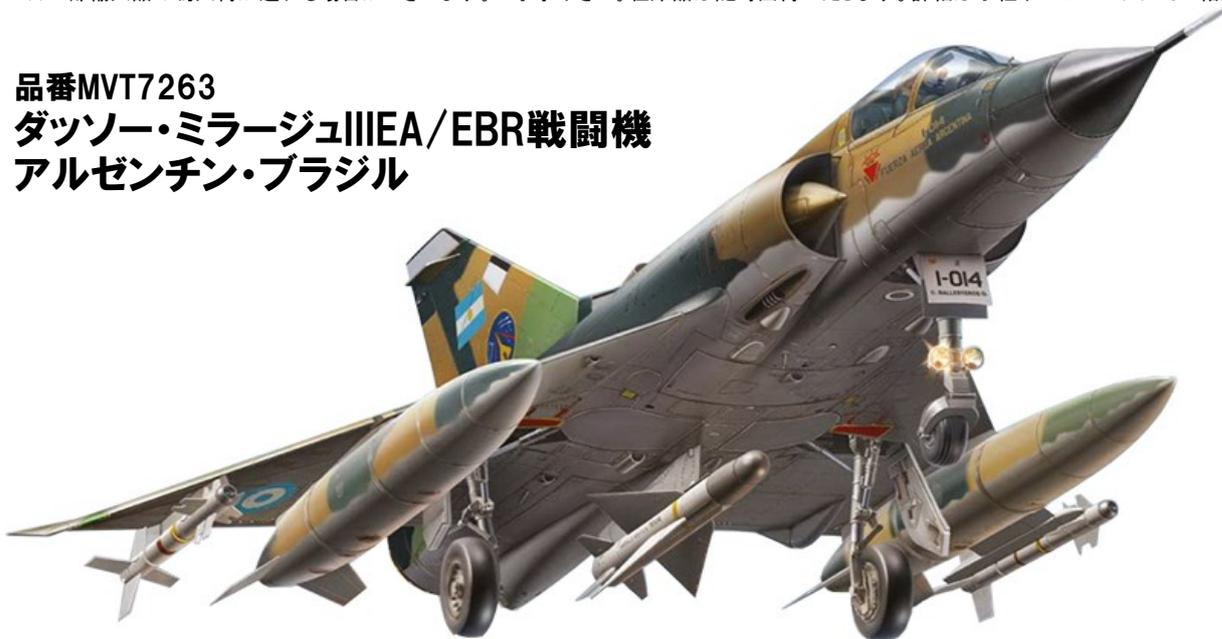
無尾翼デルタが特徴のミラージュIIIは欧州機で始めてマッハ2を達成した機体で1960年代から配備が始まりました。デルタ翼は構造が簡単で高速域の運動性が高く翼面積が広いため失速し難いなどの特徴がありミラージュIIIは大成功でした。フランスのみならず世界各国にも輸出され実戦経験も豊富です。EA型はアルゼンチンへの輸出型でフォークランド紛争にも使用、EBR型はブラジルへの輸出型です。
