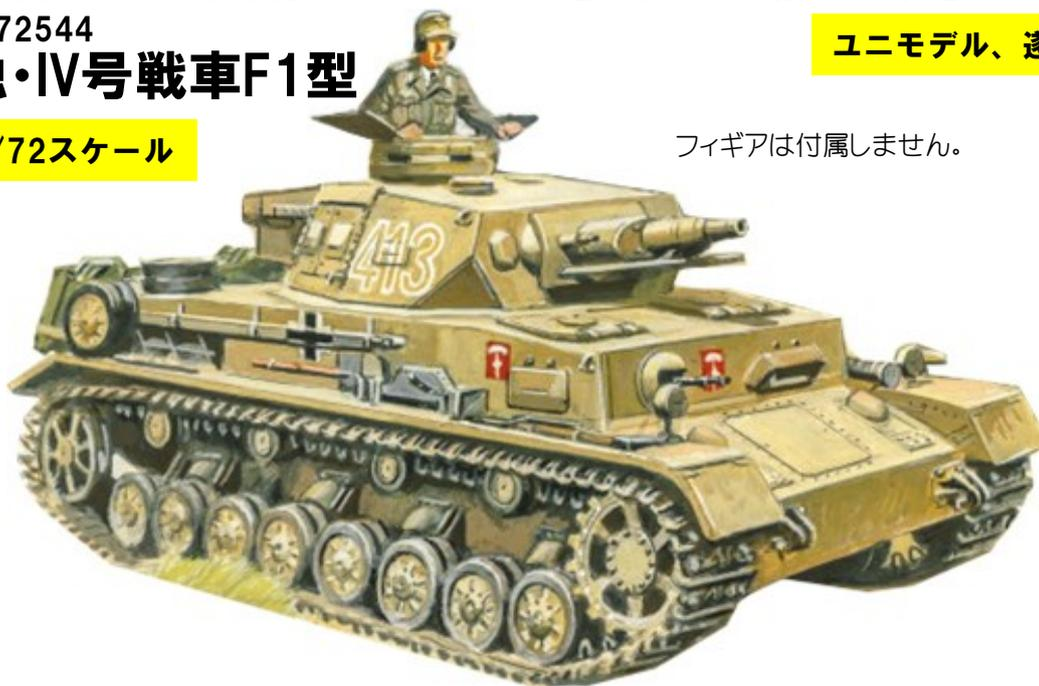
戦前のグデーリアンの構想で支援戦車として位置づけられたIV号戦車は主力のIII号が5cm長砲身で発展限界となりその後より大型のIV号が主力戦車として発展していきました。IV号F型は構造を一新した新車体で装甲も厚くなり信頼性も増しています。武装はそれまでと同じ24口径7.5cm砲でしたがこの頃から長砲身7.5cmを搭載する計画が出てきました。IV号では十分なターレットロング直径を持ち大きな改造なしに搭載可能とされ期待は高まりました。その後長砲身型はF2と呼ばれ短砲身型はF1となり主力戦車への基礎となりました。
