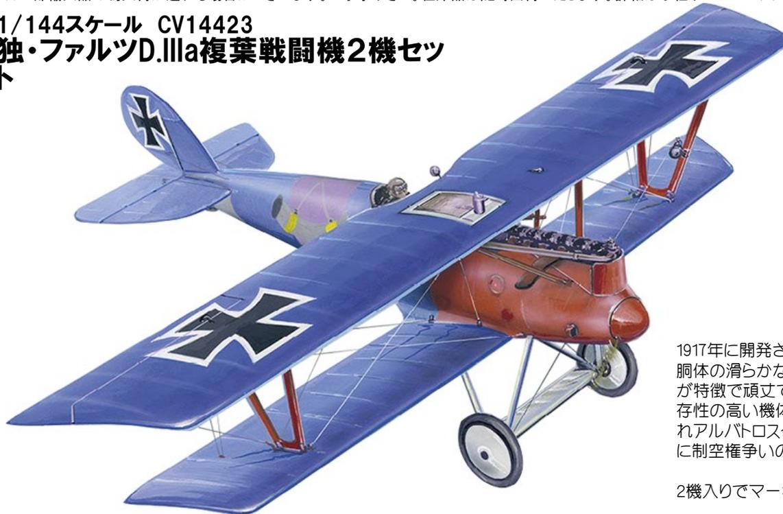
1917年に開発された複葉戦闘機です。胴体の滑らかな木製モノコック構造が特徴で頑丈で急降下速度も速く生存性の高い機体でした。大量生産されアルバトロスやフォッカーなどと共に制空権争いの一翼を担いました。
