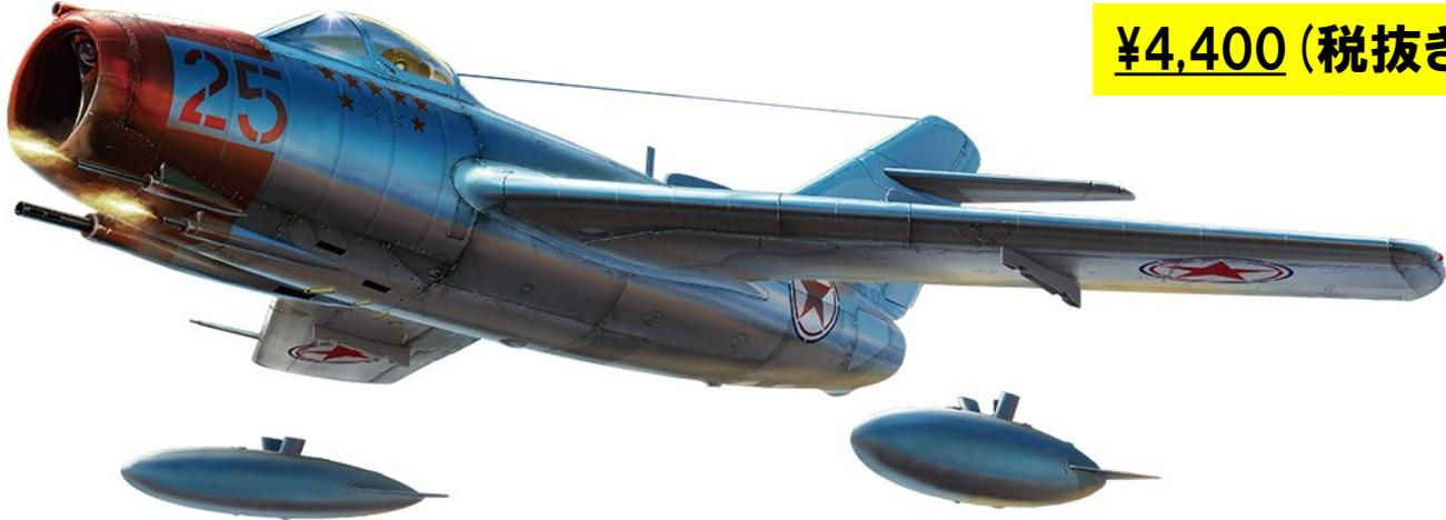
1950年に国連軍の前に姿を現せたMiG-15はそれまでの直線翼ジェット機やレブシロ機を凌駕する性能で制空権を均衡に持ち込みミグショックをもたらしました。小型軽量で後退翼を持ちエンジンは英国のニーンを国産化したRD-45を装備、機体は量産が効くように単純化され武装は37mm砲1門と23mm機銃2丁の重武装で重爆撃機も一撃で撃墜可能でした。以後、ソ連の戦闘機の名称としてミグの名は代表格として西側からは恐れられました。
