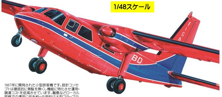
調達コストを低減させています。離島などローカル路線での運用に的を絞った設計は大型フラップの採用のSTOL性、乱気流などにも強い安定性、固定脚使用で無駄な機構の排除機内通路を廃止し側面ドアからの搭乗などにも見て取れます。 イギリス領フォークランド諸島ではフォークランド政府のアイランダーが各島の連絡に使用されていま
