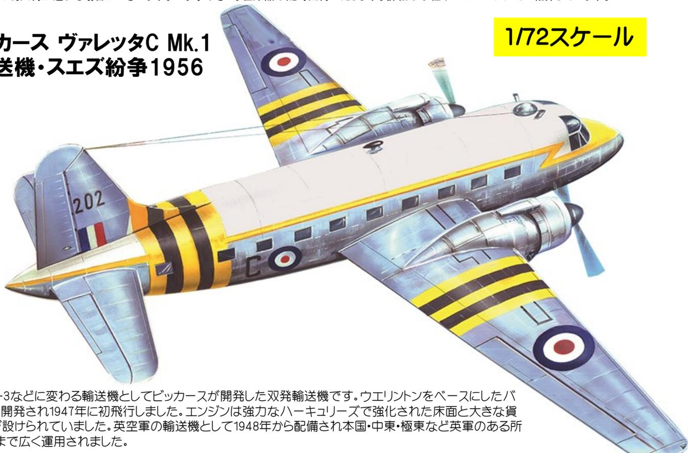
大戦中のDC-3などに変わる輸送機としてビッカースが開発した双発輸送機です。ウエリントンをベースにしたバイキングから開発され1947年に初飛行しました。エンジンは強力なハーキュリーズで強化された床面と大きな貨物積載ドアが設けられていました。英空軍の輸送機として1948年から配備され本国・中東・極東など英軍のある所に1960年代まで広く運用されました。
