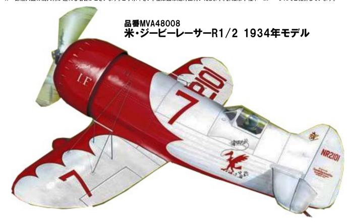
P グランビル・ブラザース社が開発したレース用単発機です。小型軽量機体に大馬力エンジンを搭載し速度記録更新を目指していました。R1はスピード競技用として製作されました。1933年に墜落したため胴体を延長した改設計タイプとしてR1/2が製作されました。主翼を製作時間短縮のためR2から流用しています。このR1/2は多くの記録を打ち立てたジービーシリーズ最後の機体となりました。
