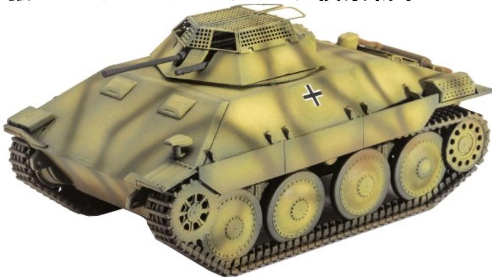
ベルゲヘッツァーの車体を利用した偵察戦闘車です。車体上部にはヘンゲラフェツェ38が搭載された。これは2cm KwK38と同軸の7.92mm MG42機銃を揺動式に装備するオーブントップの手動全周旋回式砲塔で、俯仰角は-4~+70度で対空射撃も可能でした。
